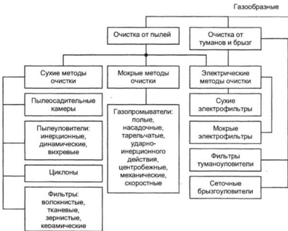
Рисунок 1 Классификация методов и аппаратов для обезвреживания газовых выбросов
