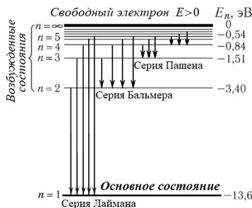
Рис. 15.1. Энергетическая диаграмма стационарных состояний атома водорода
