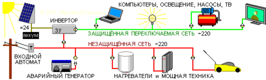
Рис. 2.2 Схема электроснабжения с переключаемым защищенным сегментом.
