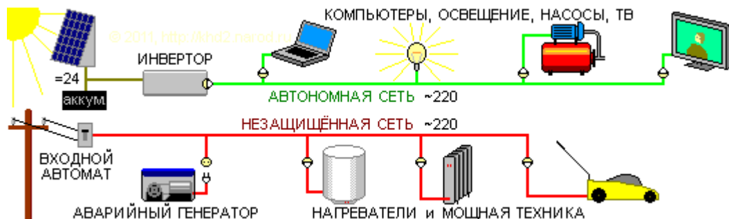
Рис. 2.1 Схема электроснабжения с автономным защищённым сегментом.
