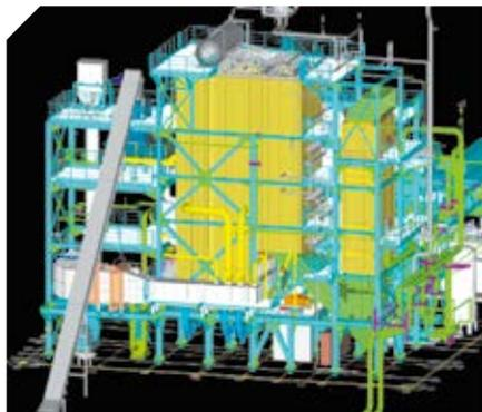
механического недожога. Водоохлаждаемая вибрационная решетка требует низких расходов на техническое обслуживание. Запальная газовая горелка используется для розжига биотоплива.
