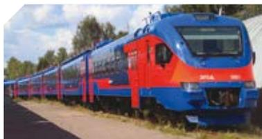
Электропоезд ЭПЗД основной составности состоит из 8 вагонов (двух головных, четырех моторных и двух немоторных вагонов).
