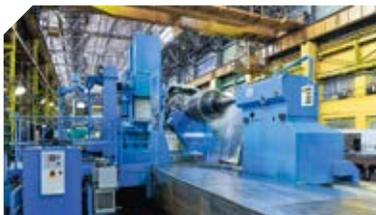
Окончательная **сборка готовых изделий**, в том числе крупногабаритных установок, происходит в механосборочном испытательном цехе КТЗ на технологическом стапеле. Специалисты отдела технического контроля следят за процессом сборки и обвязки изделия, а также проверяют на соответствие требованиям чертежа. После сборки машины транспортируют на испытательный комплекс, где изделие перед отправкой заказчику проходит испытания в условиях, максимально приближенных к реальным.
