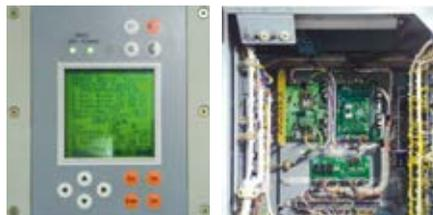
Микропроцессорная система управления преобразователем ТРПЧ
