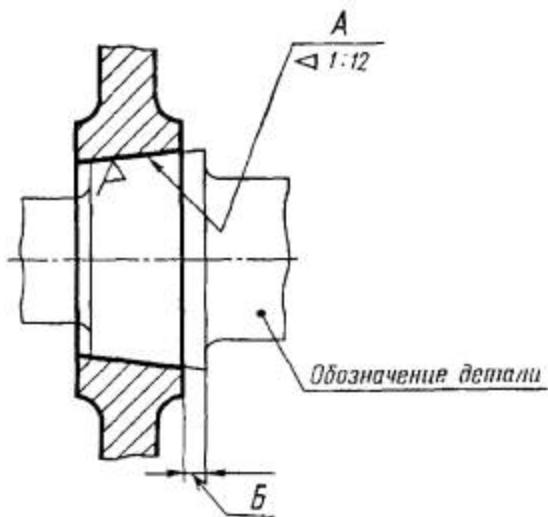
1. Поверхн. А обработать по дет. ..., выдержав размер Б.
