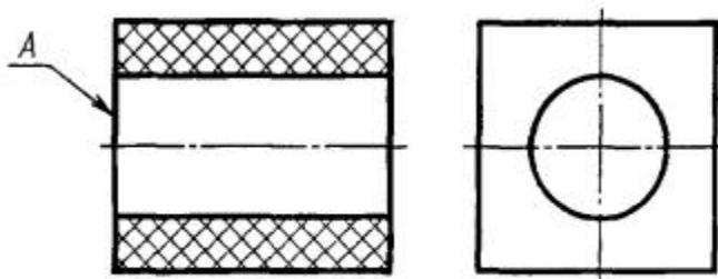
*Расположение слоев - параллельно поверхн. А*
