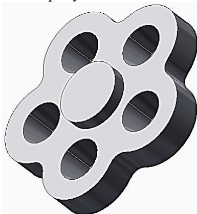
Рис. 4.14. Маховик с коническими отверстиями
