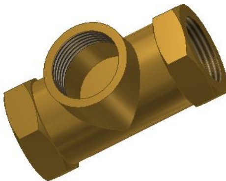
Рис. 1.21. Построение резьбового отверстия
