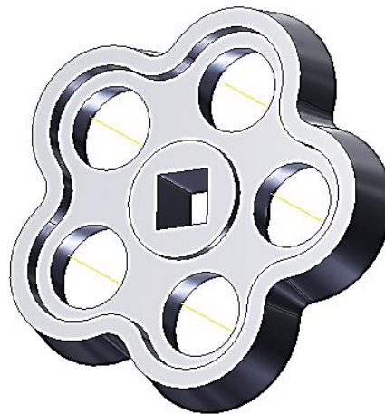
Рис. 4.22. Построение сквозного призматического отверстия
