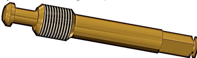
Рис. 8.7. Завершенная модель шпинделя
