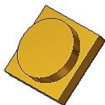
Рис. 8.2. Добавление цилиндрического элемента
