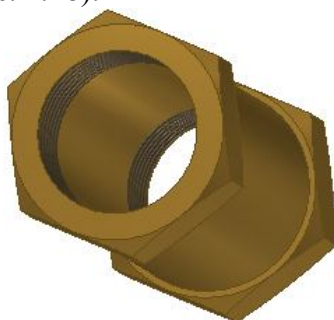
Рис. 1.18. Создание сквозного отверстия с резьбой
